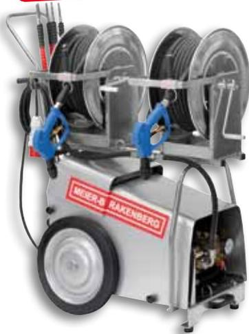
Das Top-Gerät unter den mobilen Hochdruckreinigern bietet Wasserleistung bis 3000 l/h bei 130 bar. Dank der Frequenzregelung passt sich die Drehzahl der geforderten Wasserabnahme an. So können 2 Anwender mit jeweils 25 l/min arbeiten oder z.B. mit 20 und 30 l/min.
